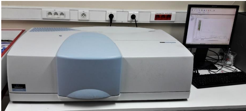
Figure 19 : Spectromètre Perkin Elmer Precisely Lamda 1050 UV/VIS-NIR Bruker.
