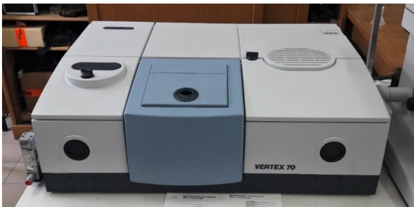
Figure 18 : Spectromètre infrarouge à transformée de Fourier (FT-IR) de type Bruker modèle Vertex 70.
