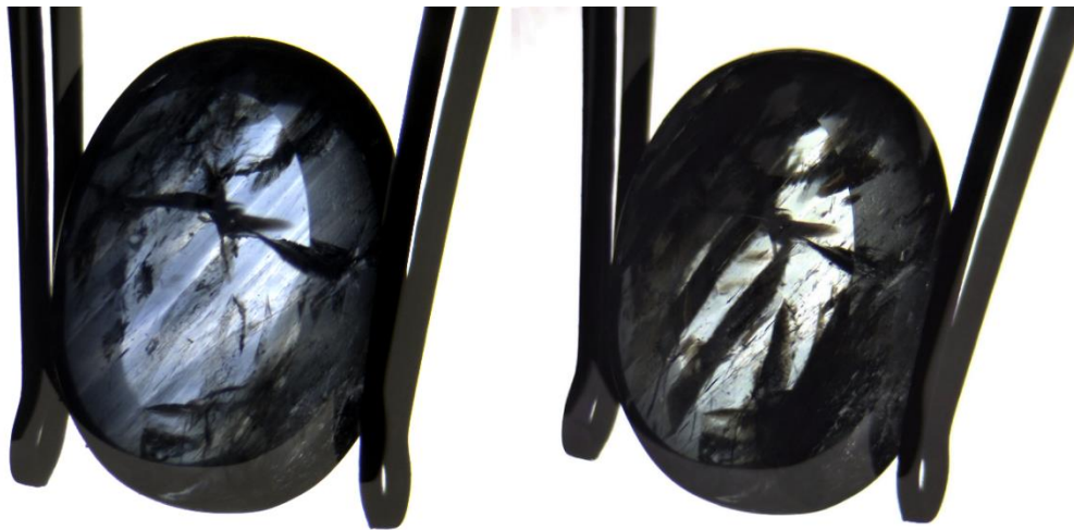
Figure 31 : Les zonations de couleur sont beaucoup moins marquées après traitement qu'avant traitement. Lumière transmise (x15).
