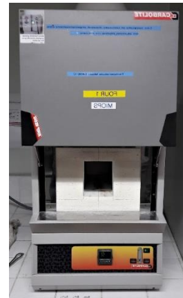
Figure 20 : Four électrique Carbolite modèle RHF 1500.
