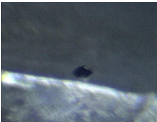
Figure 57 : une fracture discoïdale autour du cristal et un aspect ouaté du cristal est visible après traitement (à droite). Lumière latérale (x180).
