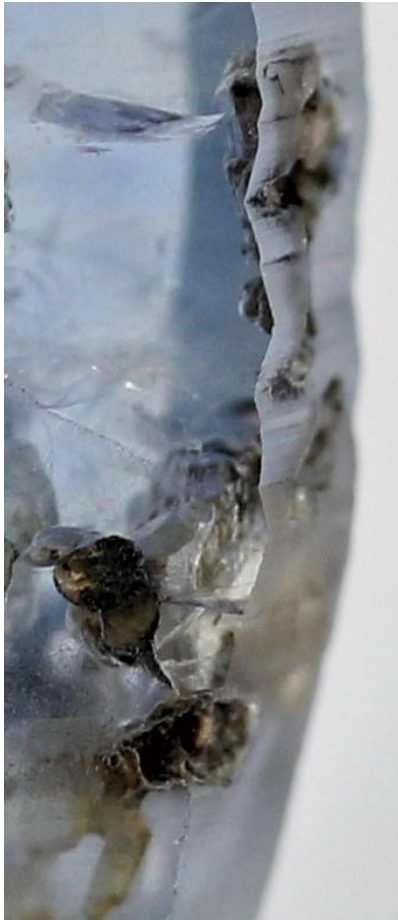
Figure 45 : Cavités affleurantes présentant un remplissage brun - jaune (avant traitement).
