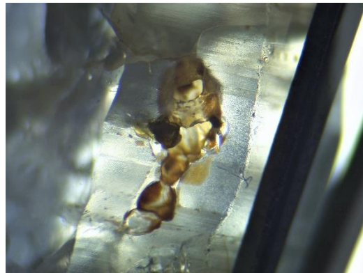
Figure 47 : Ces mêmes cavités altérées par le traitement qui présentent des traces de couleur rouille.
