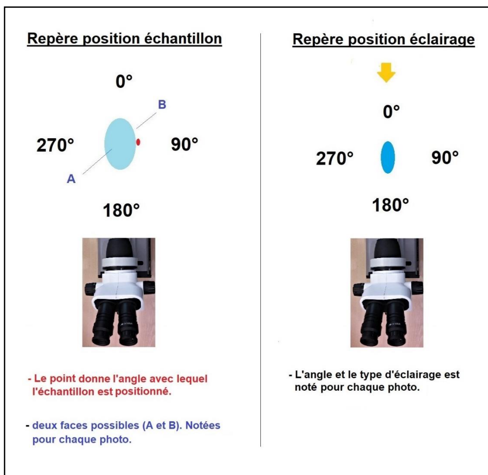
Figure 13 : charte de repères pour la position des échantillons sous le microscope et la position de l'éclairage.
