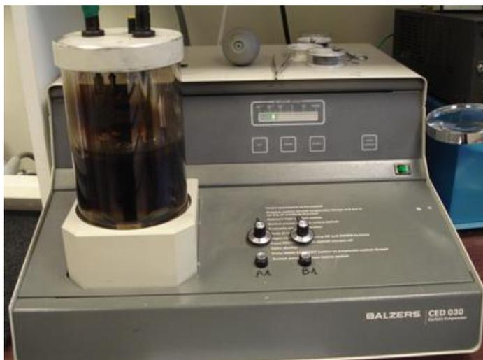
**Fig. 3.II.2 : Métalliseur à tresse de carbone
