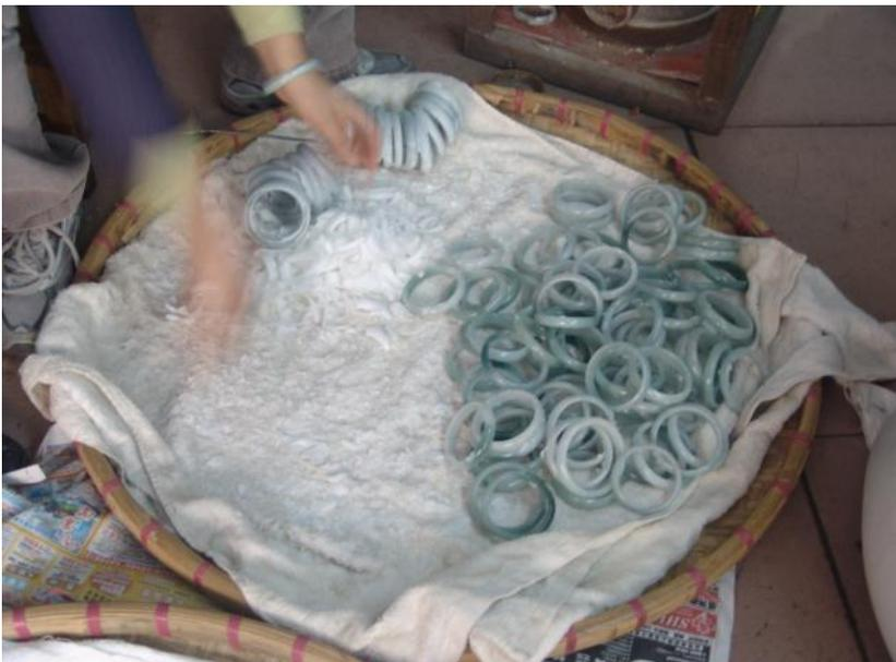
**Fig. 2.II.2 : Ouvrière retirant l'excédent de cire avant le polissage de finition. (Photo : Zhu Yuanyi)**
