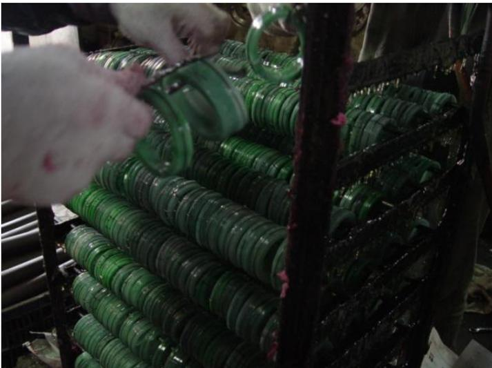
**Fig. 2.II.12 : Installation des bracelets pour le séchage. (Photo : Zhu Yuanyi)**
