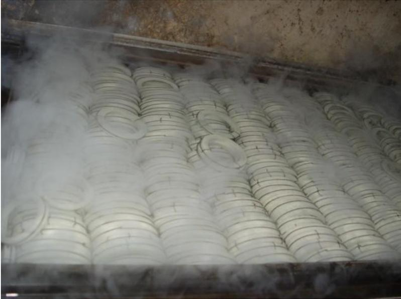
**Fig. 2.II.7 : Bracelets baignant dans de l'hydroxyde de sodium (soude). Chaque bracelet est entouré d'un cerclage en métal. (Photo : Zhu Yuanyi)**
