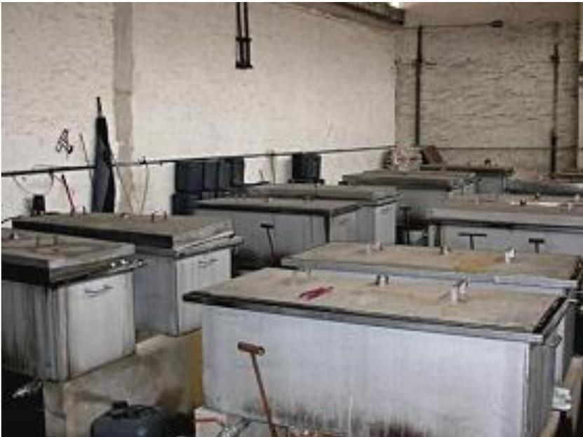
**Fig. 2.II.22 : Cuve pour les traitements à l'acide et à la soude. (Yuan, 2005)**
