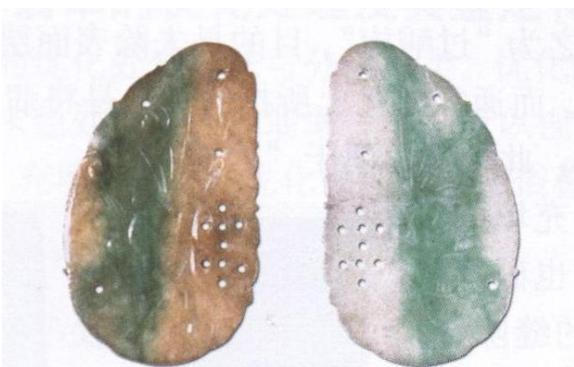
**Fig. 2.II.15 : Gauche : jadéite naturelle. Droite : après traitement chimique, les "souillures" ont disparus.** Source : Zhang, 2006.
