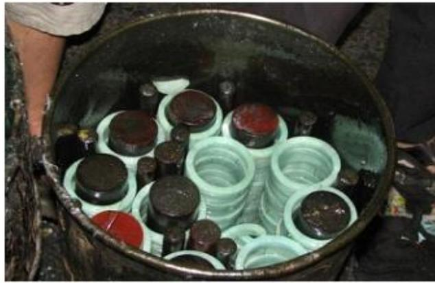
**Fig. 2.II.10 : Bracelets avant imprégnation de résine. (Photo : Zhu Yuanyi)**      **Fig. 2.II.11: Bracelets imprégnés qui vont être retirés de la cuve.**
