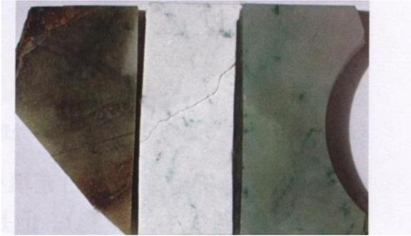
**Fig. 2.II.16 : Gauche : jadéite naturelle ; centre : après traitement chimique ; droite : jadéite imprégnée de résine.** Source : Zhang, 2006.
