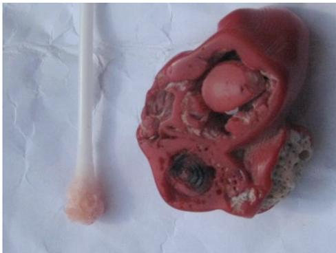
Figure 118 : Essais de décoloration à l'acétone sur l'échantillon de corail bambou CBT2. Photo x1
