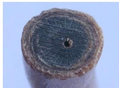
Figure 126 : Le traitement attaque les couches superficielles des branches qui restent noires au centre. Échantillon d'Antipathes CNTr3, photo x10
