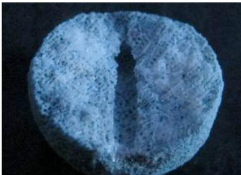
Figure 117 : Malgré la porosité sur l'échantillon Cble3, la couleur ne pénètre pas à cœur.
