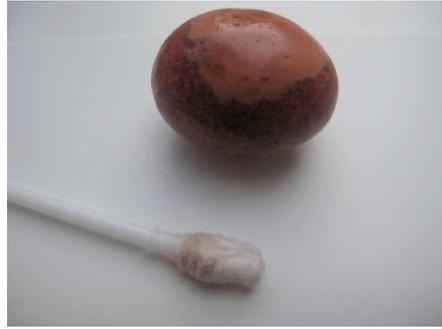
Figure 131 : Réaction de l'amalgame à l'acétone. Échantillon Rec3, photo x1,5. Le matériel de bouchage est constitué de colle, de pigment rose et de craie (type blanc de Meudon).
