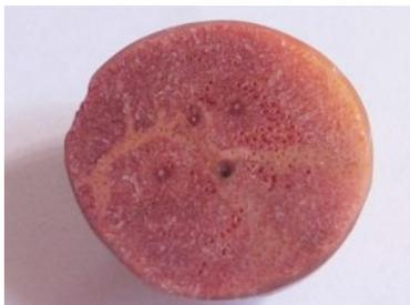
Figure 121 : Perle en *Melithaea* recouverte de résine et imprégnée quasiment jusqu'à cœur
