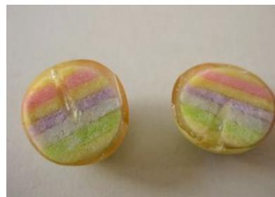
Figure 135 et 136 : L'une des perles de l'ensemble Rec5 a été sciée afin de mieux voir l'épaisseur de résine et l'assemblage de la perle. Photo x1.
