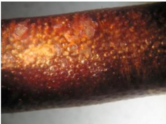
Figure 194 : Échantillon Cntr1, la surface est brûlée par le traitement.
