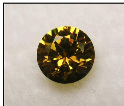
Figure 52 : Le specimen chauffé une fois taillé pèse 0.29 ct et est de couleur jaune-orange.
