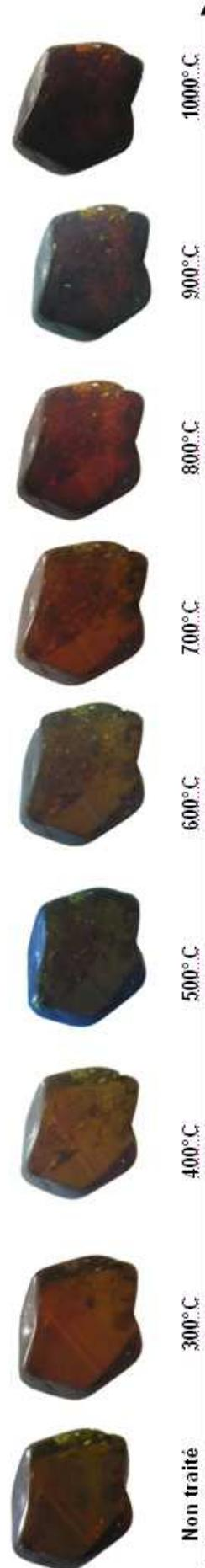
Figure 61c : Evolution de la couleur des échantillons TTA17, TTA18 et TTA19 en fonction de la température de chauffage. Color evolution of the TTA17, TTA18 and TTA19 samples, according to the temperature of heating.
