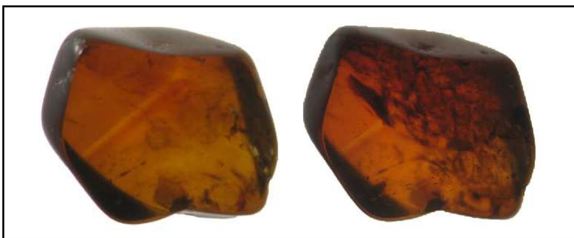
Figure 63 : L'échantillon TTA14 vu en lumière transmise. Avant le traitement (à gauche) il ne présente que quelques fractures. Après chauffage à 600°C (à droite) toute une partie du brut est sillonnée de fractures.
