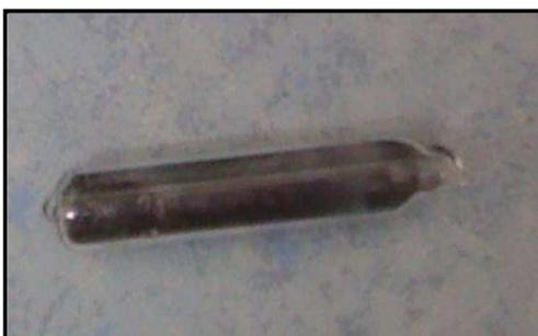
Figure 53 : Capsule de verre, fermée, avec l'échantillon à traiter et le graphite en poudre.
