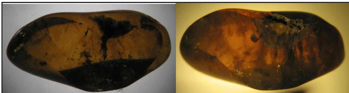
Figure 56 : Échantillon TTA15 avant (gauche) et après traitement à 700°C pendant 8 heures en conditions réductrices (droite), aucun changement de couleur observable, le graphite continue à s'introduire dans les fractures.
