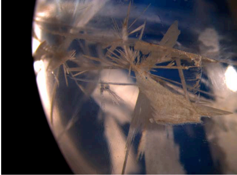
Figure 53 : inclusions « bambou » observées de manière à faire ressortir l'adulorescence bleue, QD17, x10, LR
