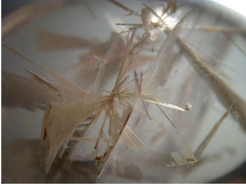
Figure 45 : multitude de canaux donnant cet aspect « bambous », QD17, x25, LT
