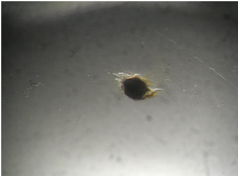
Figure 32 : cavité de surface remplie de matière organique donnant une couleur brunâtre, QD03, x40, LR
