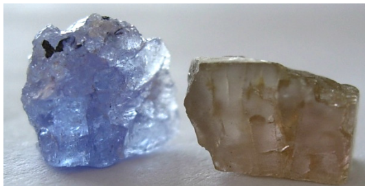
Figure 66 : Modification de la couleur de l'échantillon n° 22 après un traitement thermique. A droite de la photo, pierre orangée avant le traitement, à gauche de la photo l'échantillon est devenu bleu avec le chauffage. ( V_2O_3 : 0.07 %, Cr_2O_3 : 0.04 %) (dimensions : 4.8 x 7.3 x 9.6 mm)
