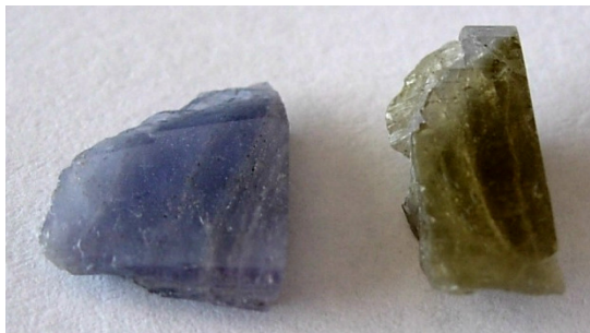
Figure 65 : Modification de la couleur de l'échantillon n° 19 après un traitement thermique. A droite de la photo, pierre verte avant le traitement, à gauche de la photo l'échantillon est devenu bleu avec le chauffage. ( V_2O_3 : 0.17 %, Cr_2O_3 : 0.15 %) (dimensions : 5.5 x 6.1 x 12.3 mm)
