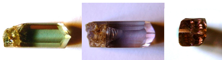
Figure 56 : Pléochroïsme de l'échantillon n° 25 selon les 3 directions cristallographiques. A gauche, le rayon bêta vert jaune ; au centre le rayon alpha violet et à droite le rayon gamma marron orange. Dimensions de l'échantillon : 5.73 x 5.98 x 15.47 mm (photos G. Bosshart).
