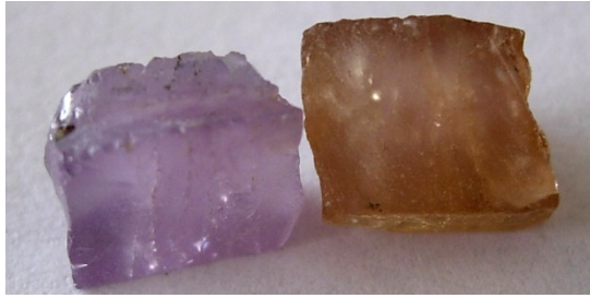
Figure 63 : Modification de la couleur de l'échantillon n° 16 après un traitement thermique. A droite, pierre orange avant le traitement, à gauche l'échantillon est devenu violet avec le chauffage. ( V_2O_3 : 0.04 %, Cr_2O_3 : 0.02 %) (dimensions: 4.9 x 6.6 x 7.8 mm)
