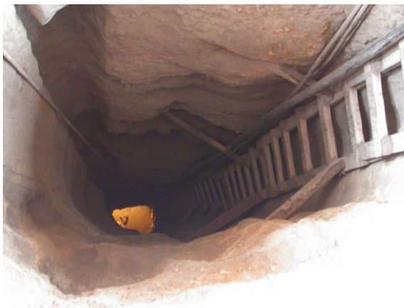
Figure 9 : Puits vertical permettant l'accès à une galerie. On aperçoit en bas de l'échelle, le bonnet orange d'un mineur. (Avec l'autorisation de J.C. Frediani)
