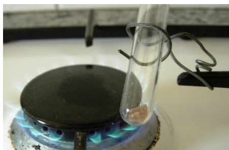
Figure 46 : La pierre orange dans le tube à essai est soumise à la chaleur de la flamme de la gazinière.
