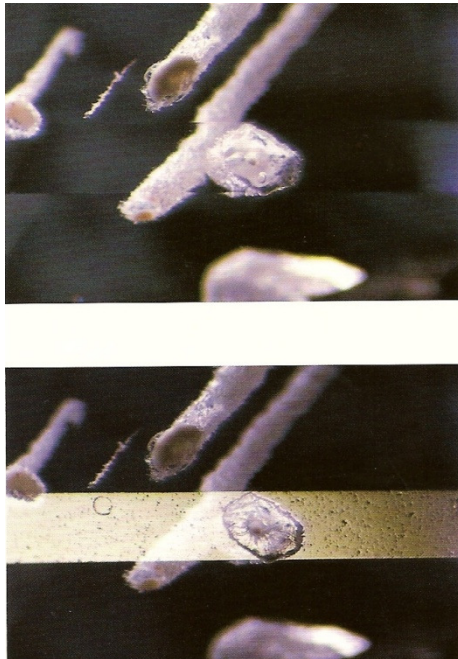
Figure 24 : Les canaux affleurant à la surface sont remplis de colle colorée. En fond noir, les bulles sont visibles dans la colle (Photo du haut). En lumière réfléchi, une différence de brillance est visible entre les canaux remplis de colle et la tanzanite elle-même. (Photo du bas) x 25 (Gübelin & Koivula, 2005)
