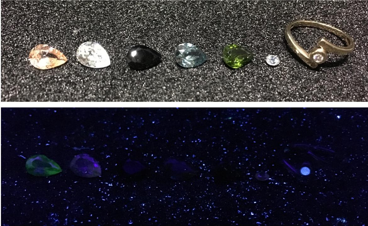
*Fig. 2. Photos des échantillons facettés exposés à la lumière de la pièce (partie supérieure), et dans le noir sous UV-longs (partie inférieure). Seul l'échantillon MD01 réagit, avec une faible luminescence verdâtre (la luminescence du diamant est beaucoup plus intense en comparaison). L'apparence légèrement blanchâtre de l'échantillon MD02 donne l'impression que la pierre réagit aussi, mais il n'en est rien. Il ne s'agit que d'un artefact lié à l'appareil photo.*
