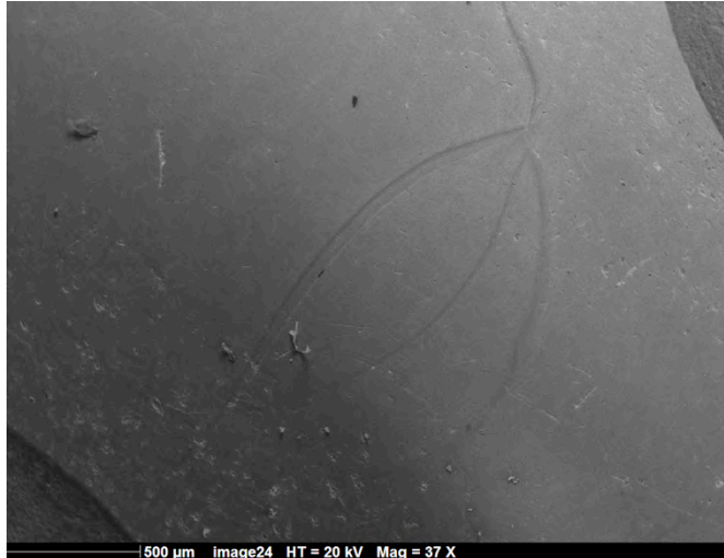
Figure 87 : Cabochon SL7 en cathodoluminescence : traces qui apparaissent.
