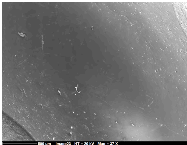
Figure 88 : Cabochon SL7 image en électrons secondaires : les traces disparaissent.
