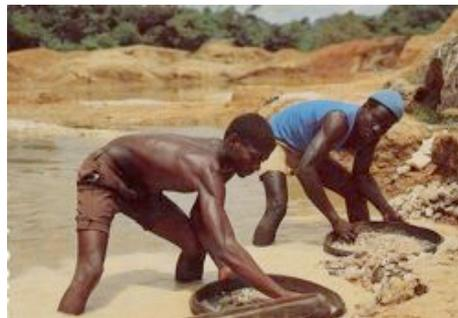
Fig. 8: Placer ; exploitation du diamant en Angola; dépôts alluviaux, gîtes secondaires (forum-politique.org).
