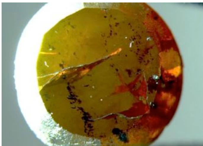
**Fig.3**: FN-363 X32: éclairage par fibre optique venant de la gauche; effet Uzambara: la couleur de masse de l'échantillon varie du jaune-vert sur la gauche à l'orange sur la droite, là où le trajet de la lumière est le plus long à traverser l'objet.
