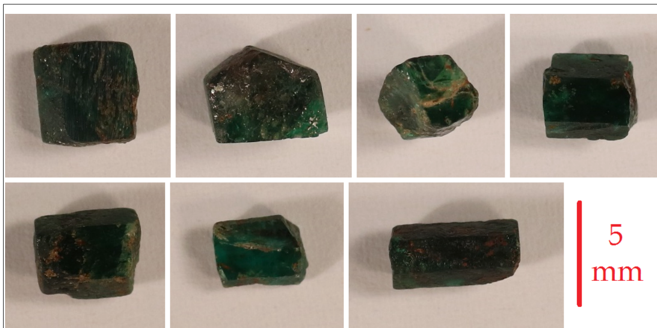
Figure 2: Set d'échantillon utilisé pour l'étude. De gauche à droite et de haut en bas : VM01 (0,68 ct ; 5,4 x 5,1 x 2,9 mm), VM02 (0,96 ct ; 5,9 x 4,4 x 3,9 mm), VM03 (0,72 ct ; 5,2 x 4,7 x 3,9 mm), VM04 (0,65 ct ; 4,9 x 4,5 x 3,1 mm), VM05 (0,77 ct ; 5,5 x 4,8 x 3,1 mm), VM06 (0,29 ct ; 4,8 x 3,9 x 1,9 mm) et VM07 (0,66 ct ; 6,9 x 3,1 x 3,1 mm).
