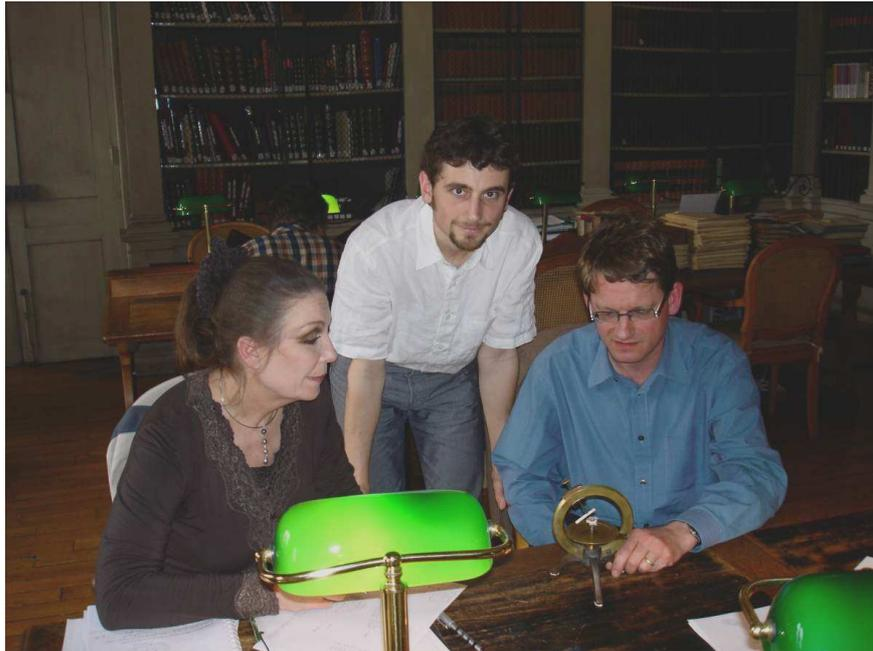
Figure 22 : Prise de mesures des angles des facettes du « Grand Condé » (goniomètre à deux cercles STOE)
