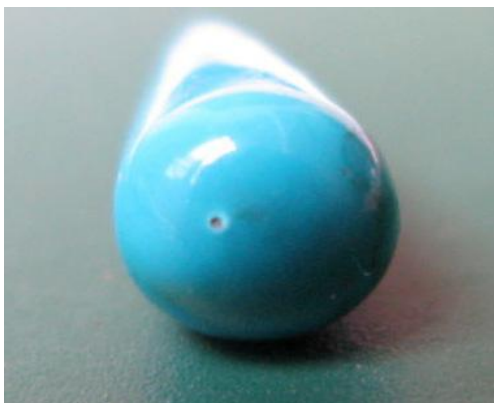
Fig. 50 : Trace de l'aiguille chauffée au rouge qui a fait fondre la résine présente dans l'échantillon CS36.
