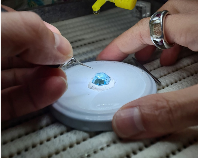
Figure 30 : Gravure au micromoteur. Photo : ©Renard Intaglio.
