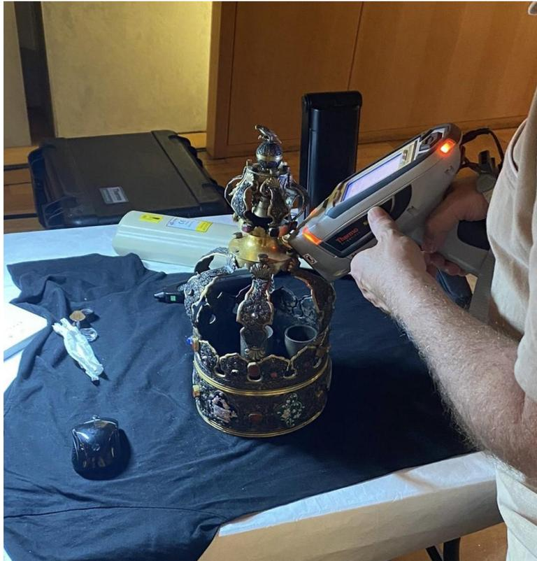
**Figure 14. Expérience d'analyse XRF portable in-situ.**
