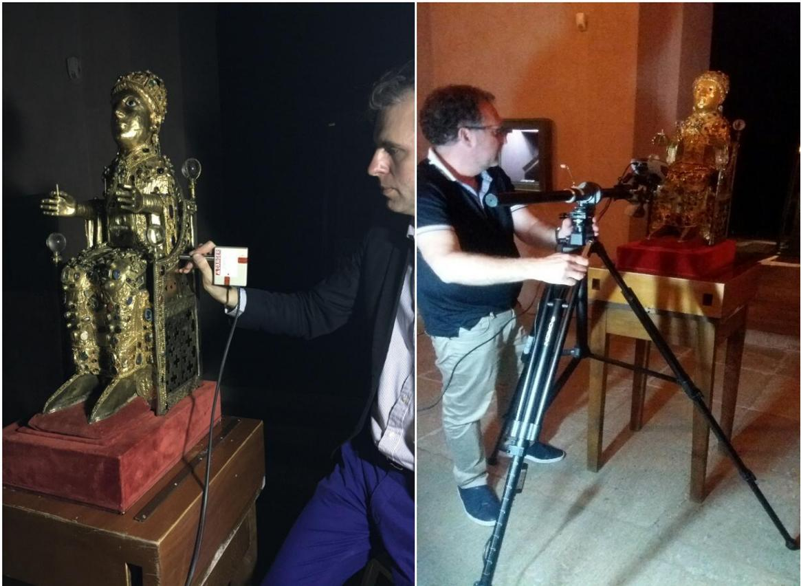
Positionnement du Raman 785 sur une gemme par M. Geoffray Riondet (lumière éteinte) et mise en place du dispositif XRF par M. Gérard Panczer.
