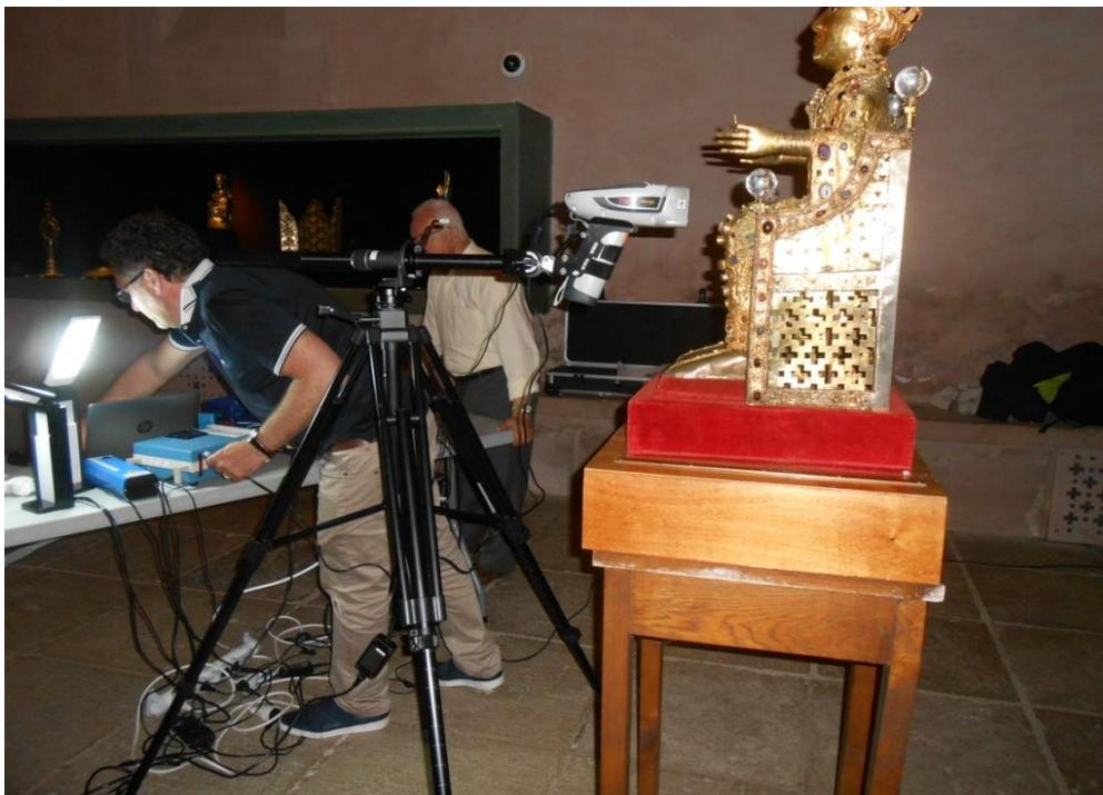
*Photo 8: installation des équipements de spectrométrie Raman et de fluorescence XRF.*
