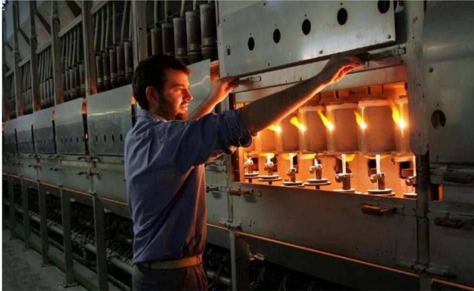
Figure 19 : Rampe de cristallisation Verneuil, composée de 45 fours
