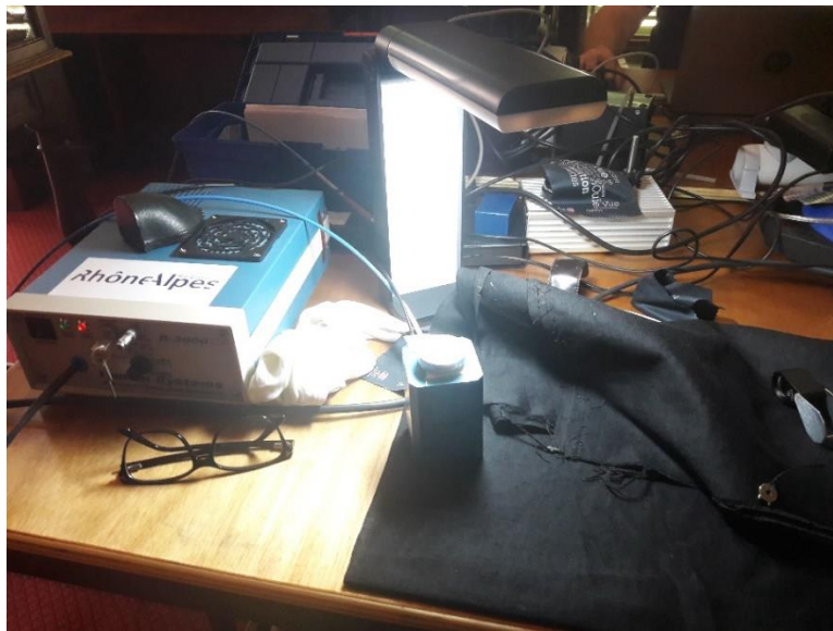
Figure 21: Dispositif du spectromètre d'absorption visible infrarouge en réflexion diffuse avec sphère intégrante
