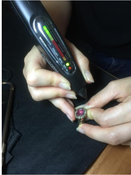
Figure 18 : Utilisation du testeur diamant/moissanite Presidium lors de nos études
