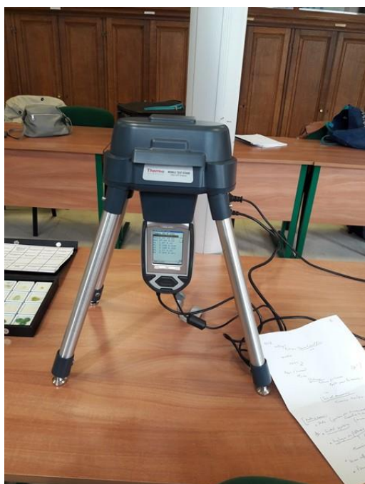
Figure 22 et 22 bis: Dispositif de spectrométrie de fluorescence X utilisé lors de notre étude et détail de la lunette lors de l'analyse de Sand 4
