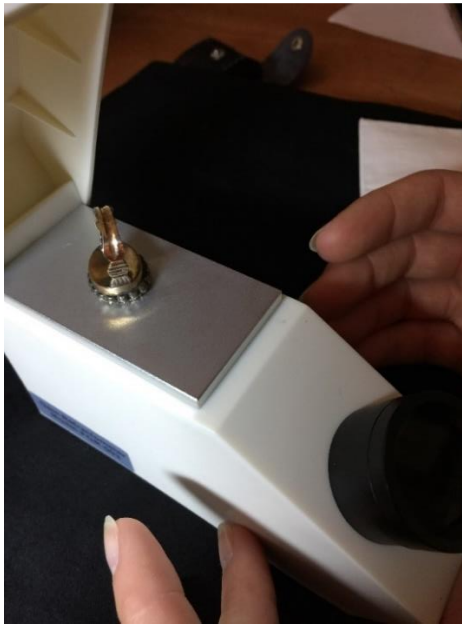
Figure 29: Sand 1: Lecture des indices de la pierre centrale au réfractomètre
