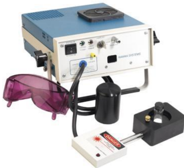
Figure 20 et 20 bis: Analyses de spectrométrie Raman conduites lors de notre étude et dispositif du spectromètre Raman R3000 (source : http://www.bihec.cn )
