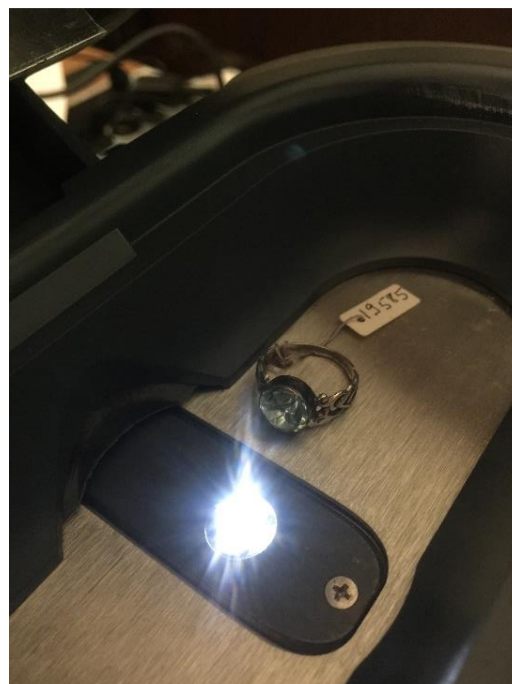
Figure 22 et 22 bis: Dispositif de spectrométrie de fluorescence X utilisé lors de notre étude et détail de la lunette lors de l'analyse de Sand 4
