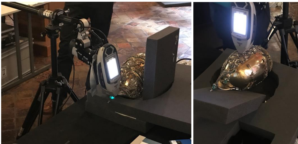
Figure 8: La tiare en cours d'analyse par fluorescence X (XRF) (photo G. Choumil).
