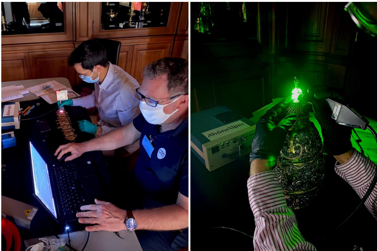
Figure 7: Analyse des gemmes du diadème (Taj) par spectromètres Raman portable Ocean Optics ; a) excitation laser 785 proche infrarouge et b) 532 nm vert (photos G. Riondet et G.Panczer).
