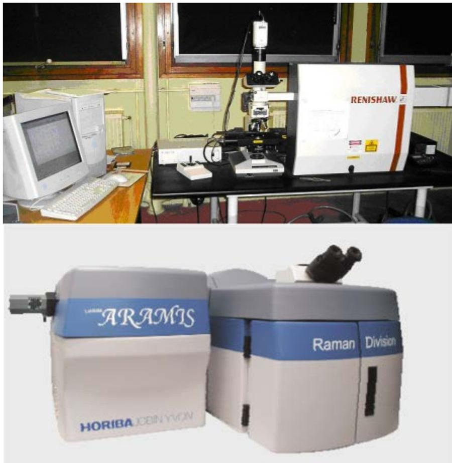
**Figure 23 : Spectromètres Renishaw et Aramis**
