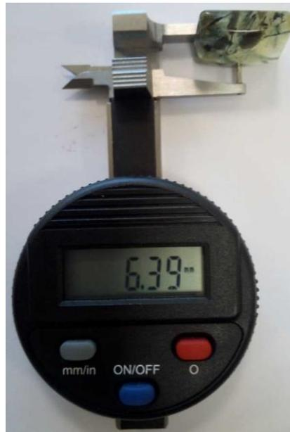
Figure 2-2 : Gauge utilisée pour la mesure des dimensions des échantillons de prehnite
