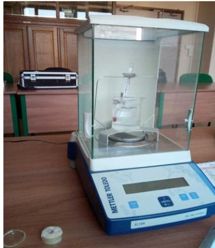
Figure 2-3 : Photo de la balance hydrostatique utilisée
