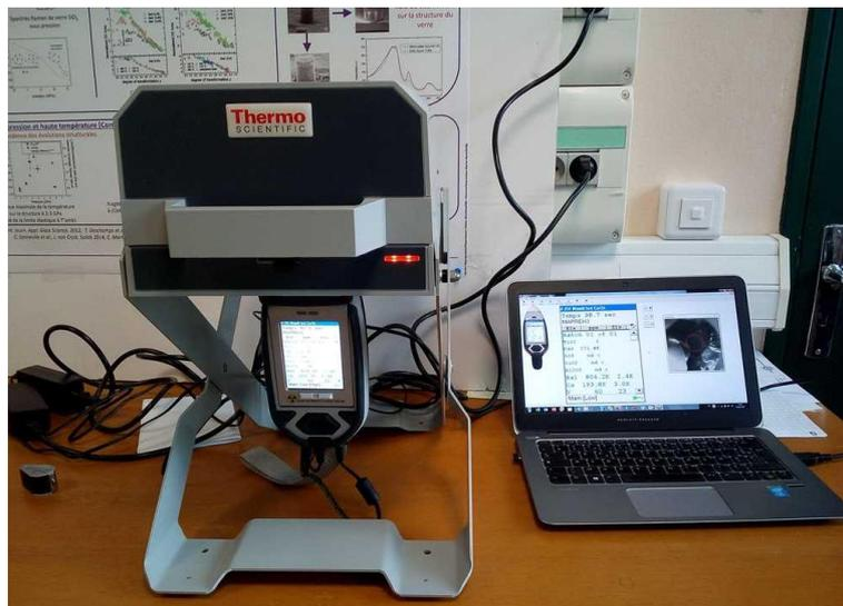
Figure 2-9 : Dispositif en cours de mesure de la fluorescence X des échantillons
