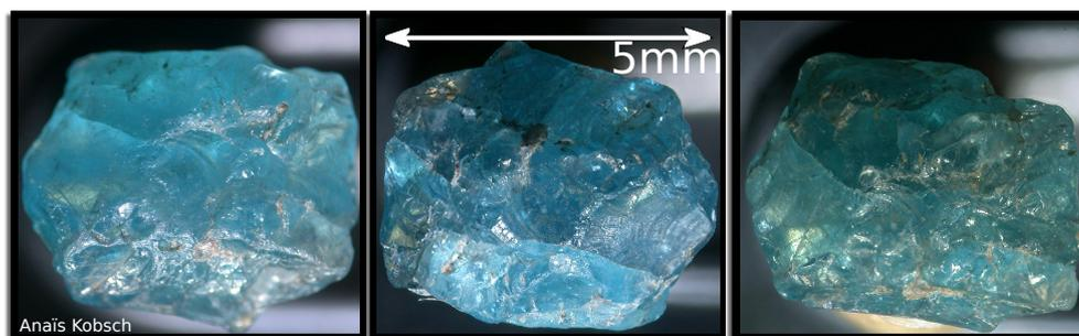
Photo 8 – De gauche à droite : échantillon E initial, chauffé à 400°C pendant 1h, et chauffé à 700°C pendant 3h.
