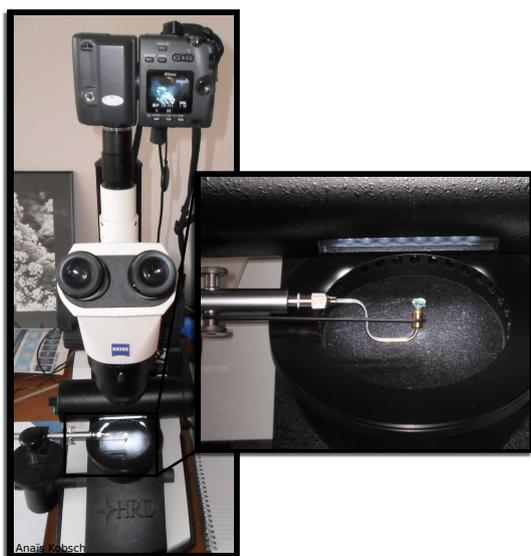
Photo 9 – Binoculaire ZEISS Stemi 2000-C et zoom sur l'embout d'aspiration maintenant une apatite gemme taillée.
