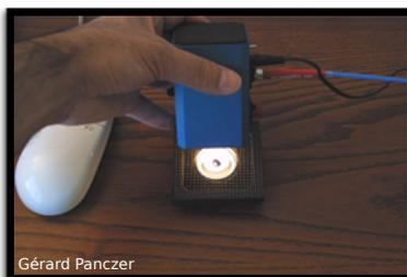
Photo 5 – Sphère intégrante du spectromètre d'absorption optique portable OceanOptics USB2000 en fonctionnement avec un échantillon en place.
