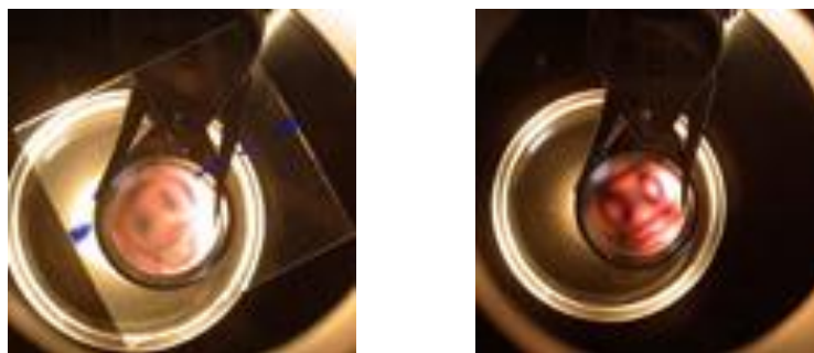
Fig. 3.6 : Photographies des interférences lumineuses d'une pierre uniaxe négative 16 :
