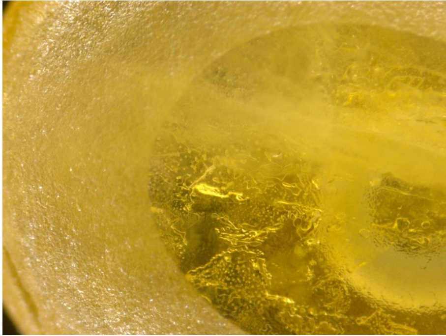
Figure 17. Givres altérés par le traitement thermique à haute température subi par l'échantillon S052101.
