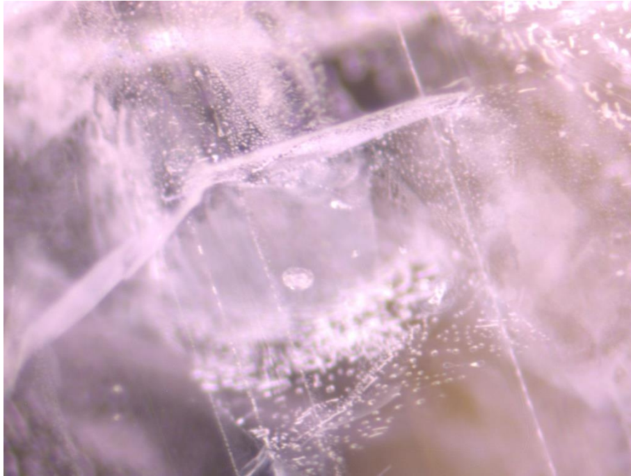
Figure 13. Cristaux et givres altérés par le traitement thermique à haute température subi par l'échantillon S052104.
