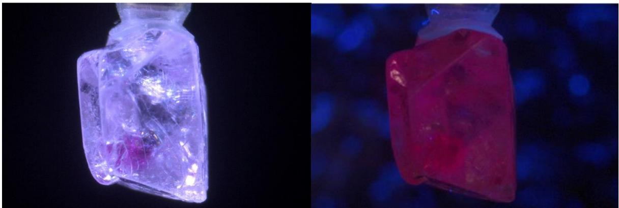
Figure 66 : SJF03 sur un de ses côtés, en darkfield à gauche, puis sous excitation UV à 365nm. Une sphère rouge est visible.
