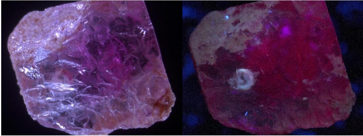
Figure 63 : De haut en bas : M13, SJF01 et SJF02 brute, en darkfield à gauche, puis sous excitation à UV 365 nm à droite. En bas, dans la SJF02, on constate des inclusions fluorescentes grisâtre à verdâtre.
