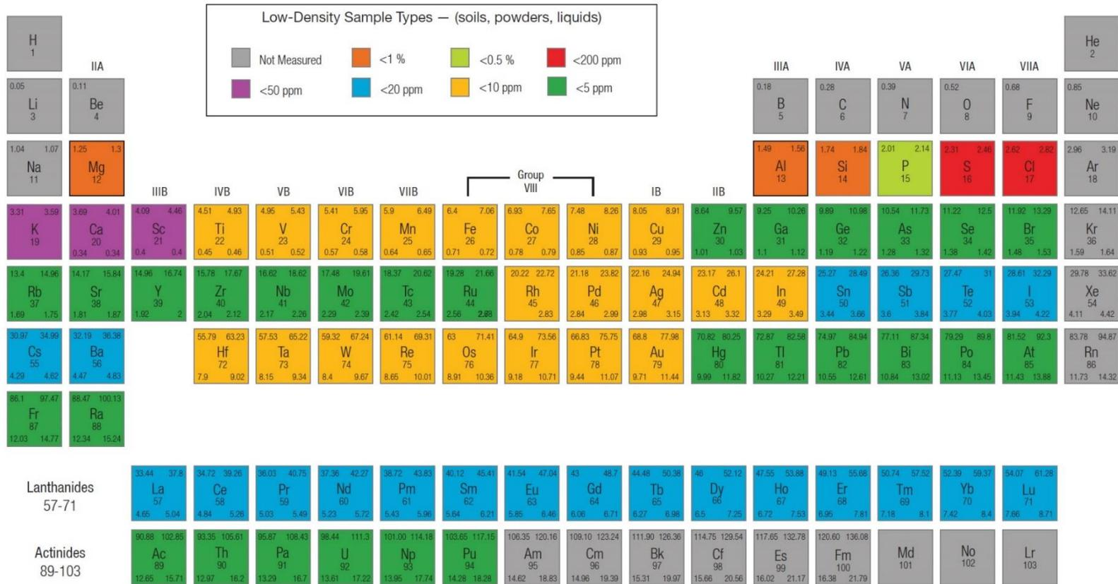
Le XRF ne renseigne que sur les éléments plus lourds que le magnésium (Mg). On pourra donc évaluer les éléments moins lourds (souffre par exemple) mais pas le Carbone, l'Oxygène et l'Hydrogène qui sont les composants principaux de l'ambre.
