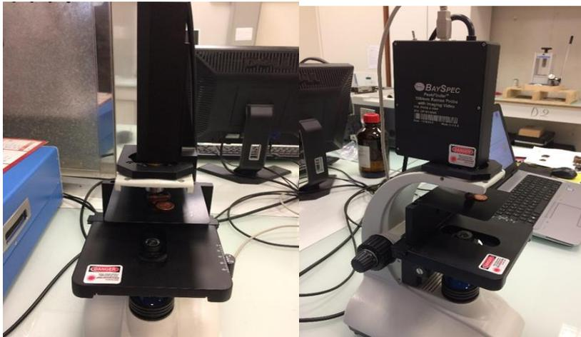
Figure 44 : positionnement des échantillons, 100 % puissance laser, faisceau de 450 mW temps d'acquisition 4 fois 30 secondes
