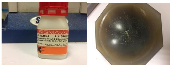
Figure 49 : préparation des échantillons d'ambre pour le FTIR
