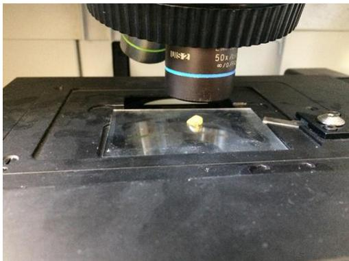
Figure 47 : dépose de l'échantillon sous le faisceau pour analyse
