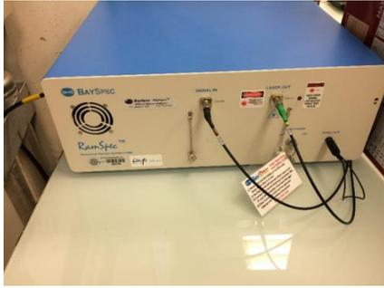
Figure 43 : spectromètre Raman excitation laser 1064 nm RamSpec™- HR
