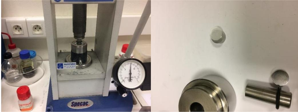
Figure 50 : La préparation est ensuite pressée afin d'obtenir une pastille pour chaque échantillon
