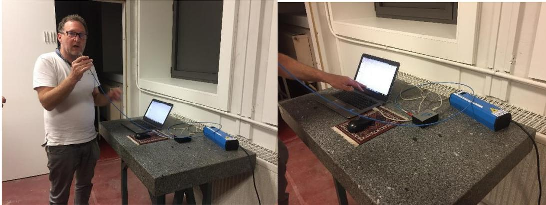
Figure 55 : Professeur Panczer préparant le protocole, fibre optique à la main (a) ; Lampe UV et spectromètre portable Oceans Optics 2000 et ordinateur portable muni du logiciel Spectra Suite (b)
