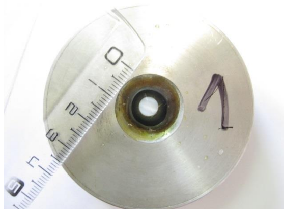
Figure 7 : Perle PC1 qui a été coupée, polie et incluse dans un socle en résine (don de Marcelle Howard)
