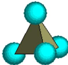
*Figure 62 : Tétraèdre d'un atome de silicium (Beige) lié à 4 atomes d'oxygène (Cyan). Sur la représentation cristallographique (Figure 64) les atomes d'oxygène ont été cachés pour une meilleure visibilité.*
