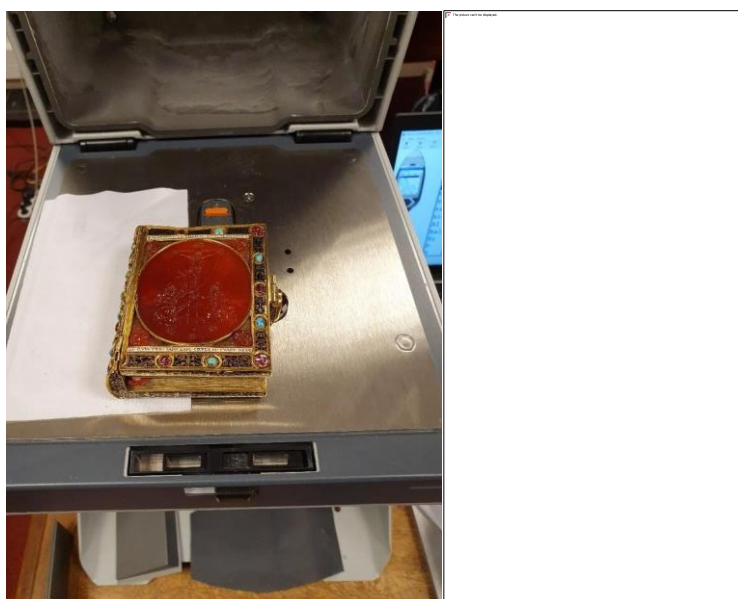
Figure 3- Livre d'heure sur le plateau d'analyse XRF (photo G.Panczer) et analyseur Thermo Niton XL3t980 GOLD (photo constructeur)
