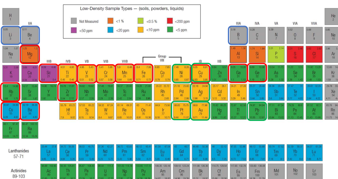
Figure 32. Tableau périodique des éléments analysables par XRF et leur limite moyenne de détection (LOD)
