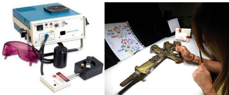
Figure 31. Spectromètre Raman portable. Acquisition des spectres Raman des pierres.
