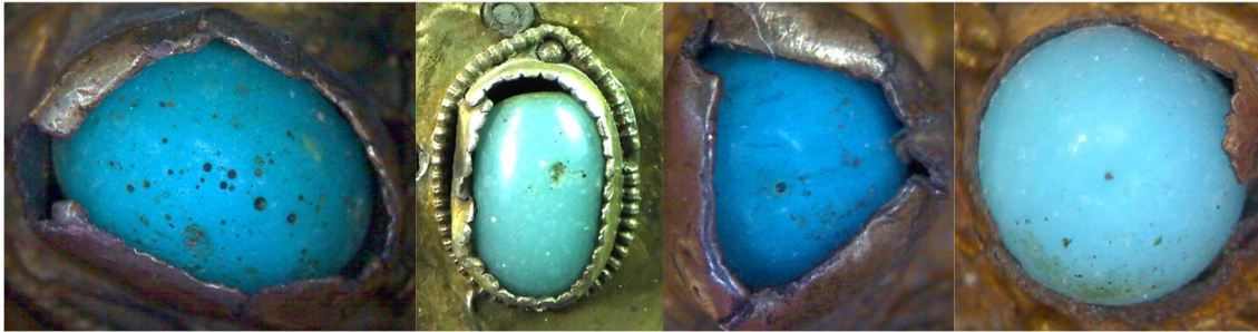
Figure 94. Observation au microscope numérique des pierres imitation des turquoises « d'origine », vitrocéramiques (ou céramiques) glaçurées. De gauche à droite, R.K.3, A.O, A.D.3, A.D.1
