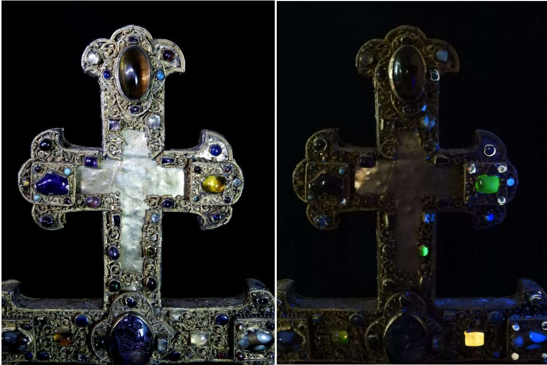
Figure 26. Observation de la croix sous UV. A gauche, photo sous lumière blanche de la partie haute du revers de la croix. A droite, la même photo sous UV longs 365nm.
