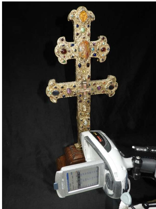
Figure 33. Analyse d'une pierre de la Croix de Gorre par XRF
