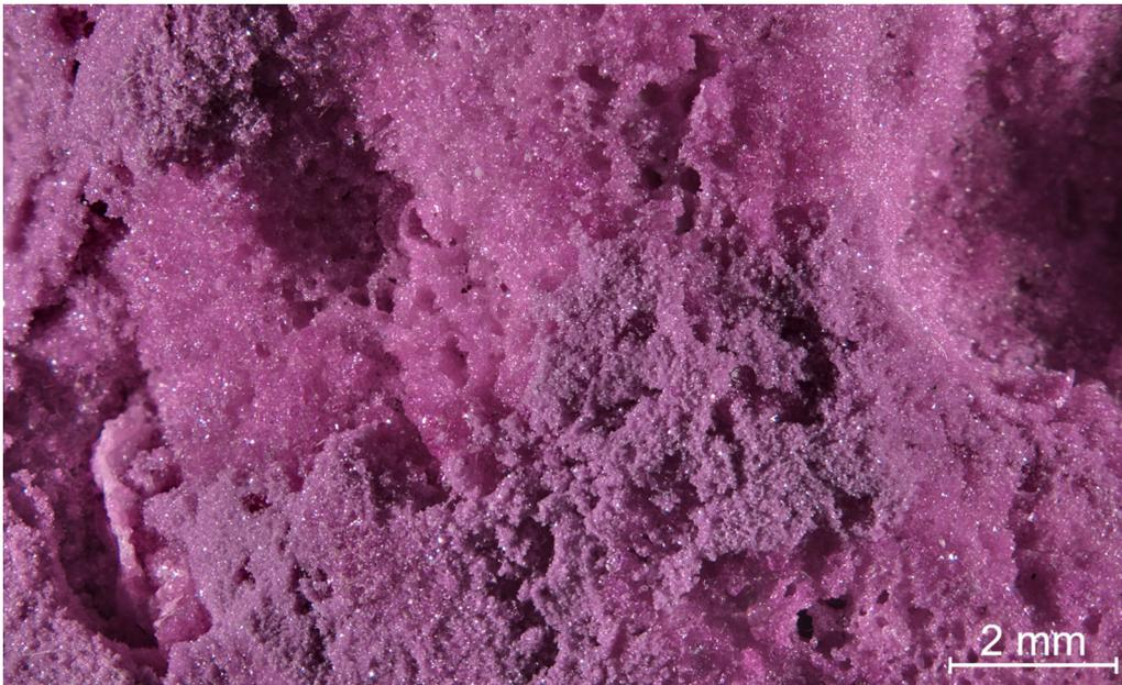
**Figure 2 :** Aspect de la partie friable où l'aspect pulvérulent est encore observable. Micrographie F. Blumentritt.
