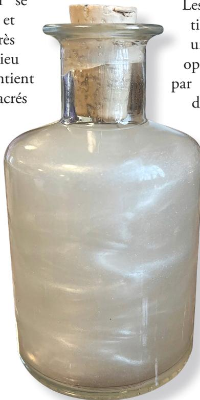
**Figure 7 :** Aspect de la solution alcoolique d'écailles de poisson malaxée et purifiée. Au repos, la solution sera limpide et transparente, après sédimentation de l'ensemble des particules fines à la base du flacon. Photo : Romain Gauthier.
