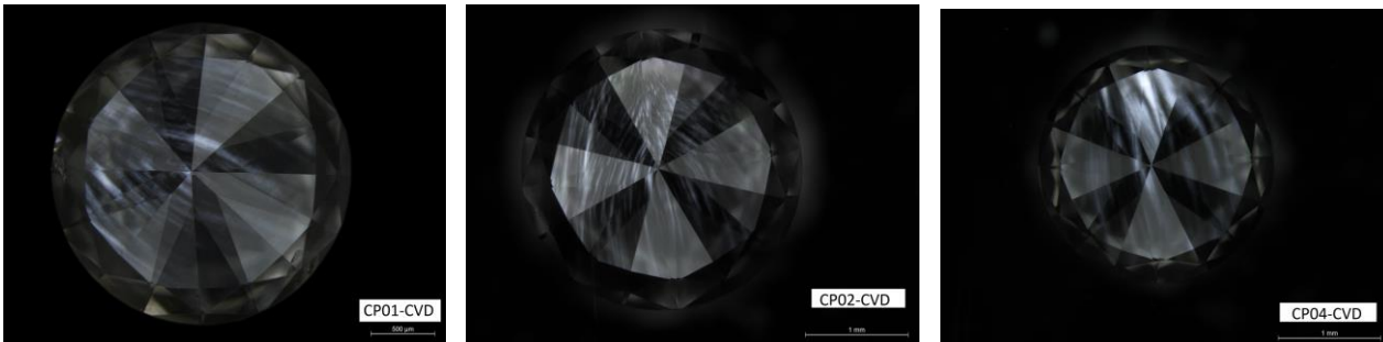
Photos 17-18-19 : Faible double réfringence des échantillons synthétique CVD CP01, CP02 et CP04 vu au microscope sous polariseurs croisés
