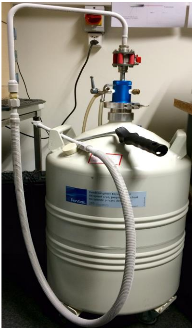
Photo 5 : Réservoir d'azote liquide
