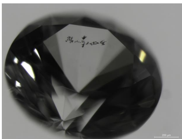
Photo 13-14 : Des inclusions métalliques dendritiques sombres ont été observés dans l'échantillon CPS03.
