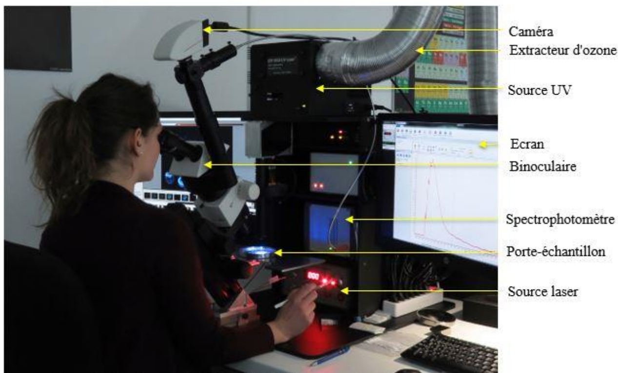
Photo 4 : Installation DFI chez GGTL Laboratories-Switzerland
