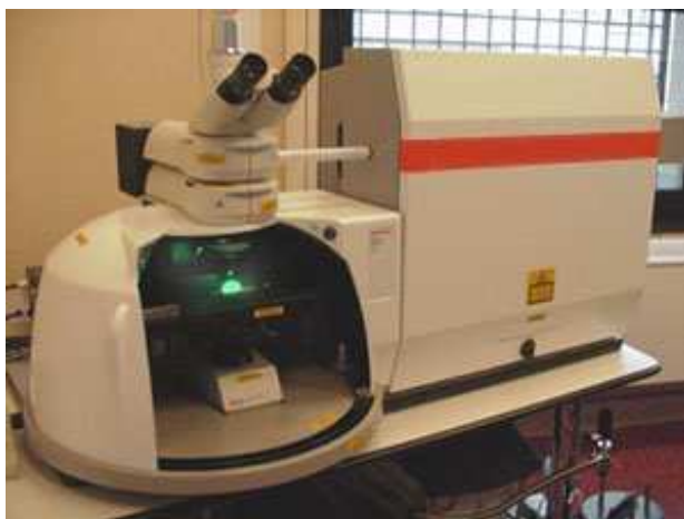
Figure 30 : Microsonde Raman du Laboratoire Français de Gemmologie utilisée afin de reconnaître la nature minérale des échantillons et des inclusions (Référence internet 3).
