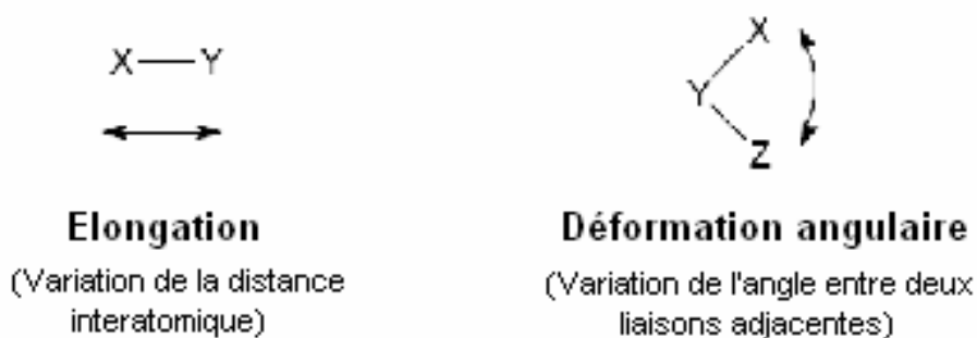
Figure 22 : Schéma simplifié de deux vibrations moléculaires, l'élongation et la déformation angulaire produisant des absorptions en infrarouge (Référence internet 2).
