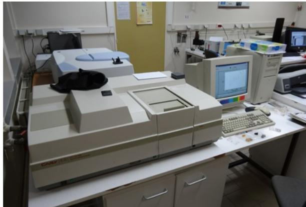
*Photo 225 Salle à l'IMN avec la machine CARY 5G, UV-Vis-NIR spectrophomètre. Le traitement des données se fait avec l'ordinateur sur la droite.*
