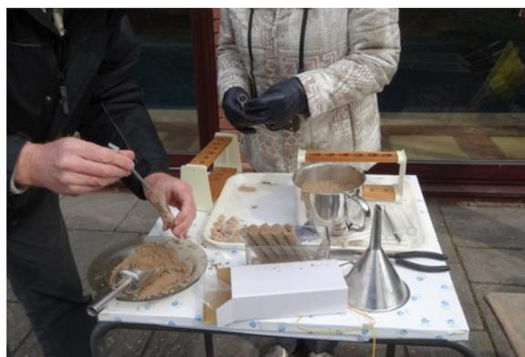
*Photo 85 Remplissage des tubes à essai. Noter le tassement du sable très fin avec le petit instrument de dentiste.*
