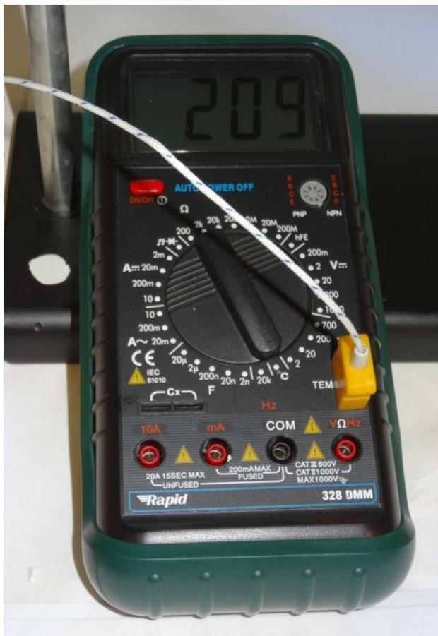
Photo 46 Testeur électrique avec prise jaune de branchement du thermocouple.
