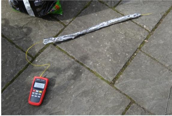
*Photo 86 Testeur électrique et le thermocouple déjà décrits . Le câble du thermocouple a été entouré d'un papier d'aluminium pour donner de la rigidité et le protéger.*
