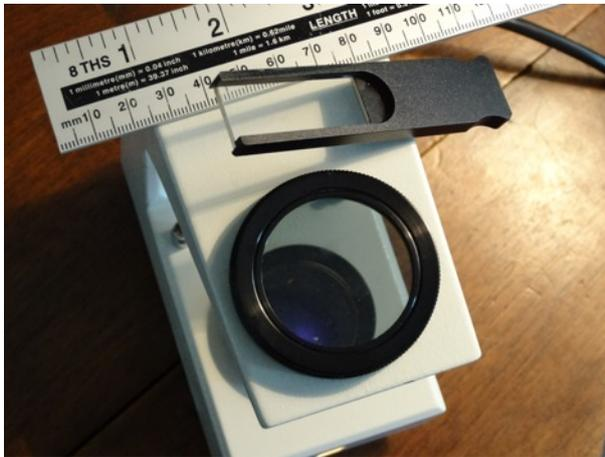
Photo 26a Polariscopes avec filtres en position croisée, règle avec graduations en cm et pouces, lame de quartz avec deux faces non parallèles et support métal noir.
