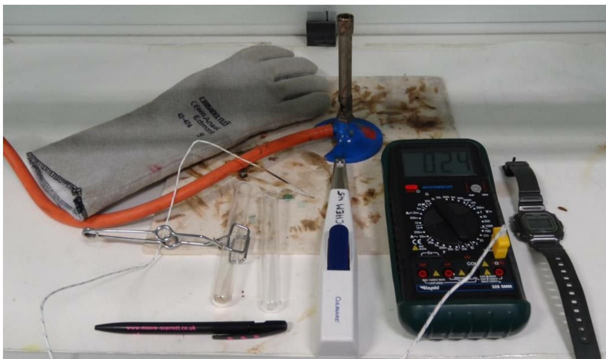
Photo 67 Matériel pour la quatrième expérience. Le tube à essai est maintenu au-dessus de la flamme par une pince, tenue avec un gant résistant à la chaleur.
