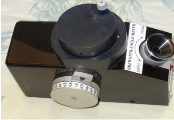
Photo 17. Appareil mesurant l'angle de Brewster avec le tambour gradué externe.
