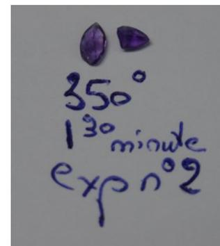
*Photos individuelles des échantillons après chauffage au bout d'un temps donné.*
