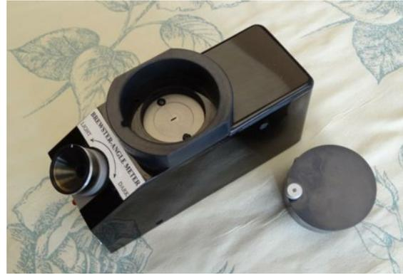
Photo 18. Le couvercle est retiré montrant la chambre de testage
