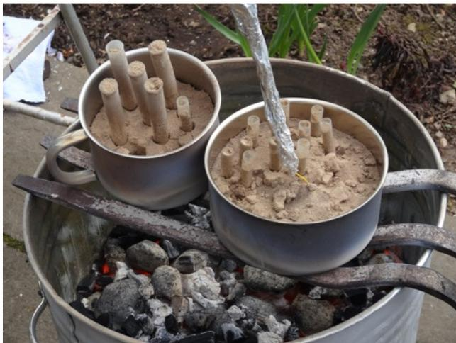
*Photo 88 Vue de détail. La grosse casserole avec 26 tubes à essai, la petite casserole avec 7 tubes. Cette photo a été prise au milieu de l'expérience et certains tubes ont déjà été retirés. Pour obtenir une température voisine de 350-400°C, les casseroles ne sont pas en contact avec les braises mais posées au dessus.*
