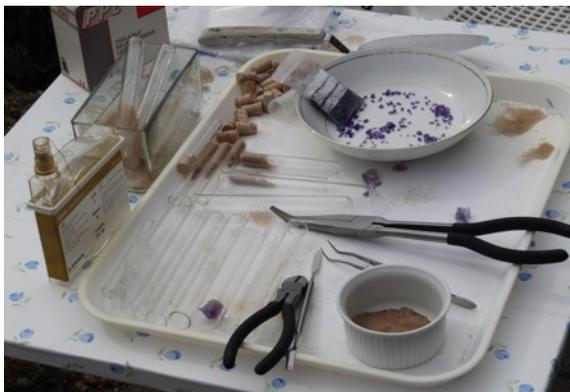
*Photo 84 Préparation des tubes à essai. Noter les petites améthystes dans la coupelle et les grandes pinces pour retirer les tubes à essai.*
