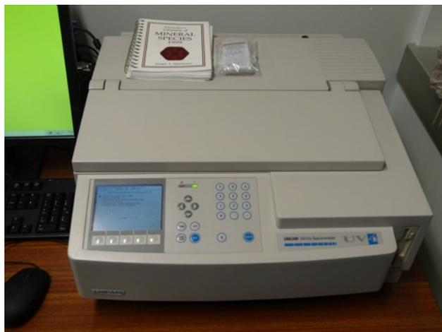
*Photo 226 Machine UNICAM UV/Vis spectromètre UV4.*
