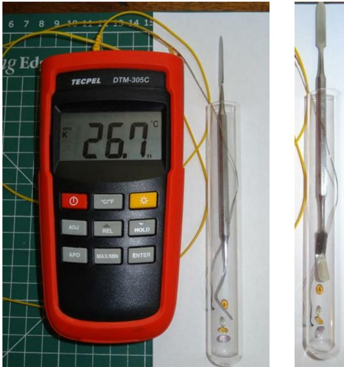
Photo 44 & 45 Testeur électrique sur lequel on branche le thermocouple et tube à essai. La spatule du petit instrument de dentiste est tournée de 90° ce qui permet de comprendre la manipulation des pierres à l'intérieur du tube à essai.
