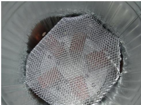
*Photo 82 Incinérateur de jardin. Pour assurer une bonne ventilation par dessous : trous latéraux et grillage posé sur des briques.*
