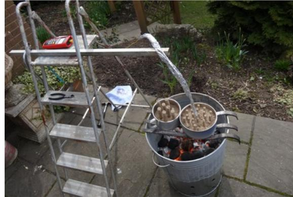
*Photo 87 Vue d'ensemble de l'expérience. La grosse casserole contient les tubes à essai avec les petites pierres, la petite casserole les fragments de la pointe cassée.*
