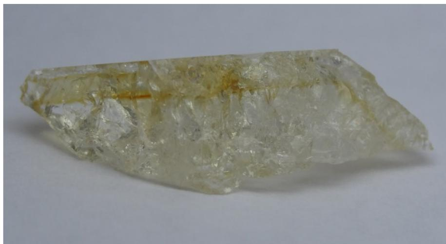
*Photo 121a* Après 7 heures de chauffage supplémentaire, l'échantillon présente une coloration hétérogène : une zone incolore, une zone jaune pâle et une zone brune/orange. Cette variation de couleur est sans doute due à une distribution de la coloration pourpre hétérogène avant chauffage.
