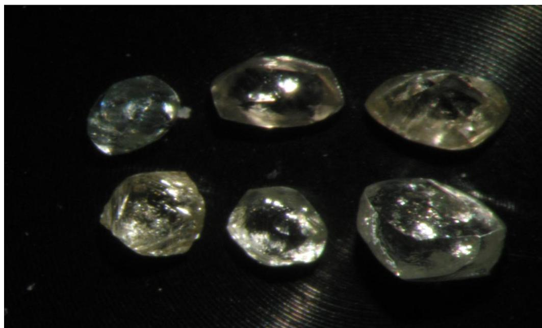
**Figure 7** : photo de six cristaux de diamants constituent un camaïeu légèrement nuancé, en haut de gauche à droite 3 rhombododécaèdres respectivement de couleur incolore (DG20, 0,09 ct), jaune (DG1, 0,31ct) et grise (DG19, 0,06 ct). En bas de gauche à droite 3 octaèdres respectivement, jaune (DG26, 0.05 ct), brun (DG27, 0.04 ct) et incolore (DG23, 0.1).
