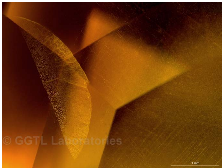
Figure 16: guérison de fracture dans un saphir naturel traité par diffusion béryllium (GGTL Laboratories, 2016).
