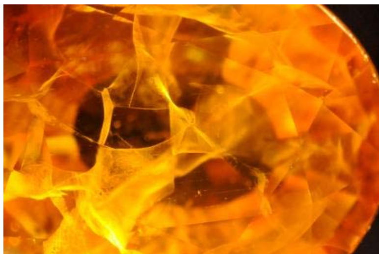
Figure 22: inclusions typiques des corindons synthétiques par fusion « quench cracked » (Gem-passion.com, 2016).
