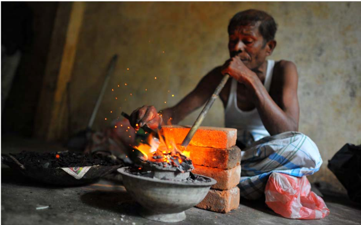
Figure 4 : burner Sri lankais utilisant la technique traditionnelle de chauffe, Photo par Vincent Pardieu / GIA (Pardieu & al, 2015).
