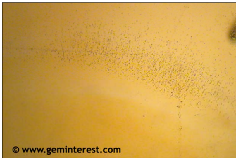
Figure 21: bulles en voiles dans un saphir jaune synthétique Verneuil (Geminterest.com, 2016).
