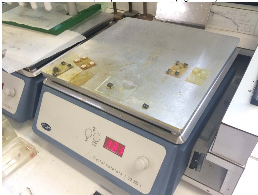
Figure 65: plaque chauffante permettant de faire fondre la résine qui servira à fixer les plots et l'échantillon sur la lamelle de verre. La température est d'environ 130 °C.
