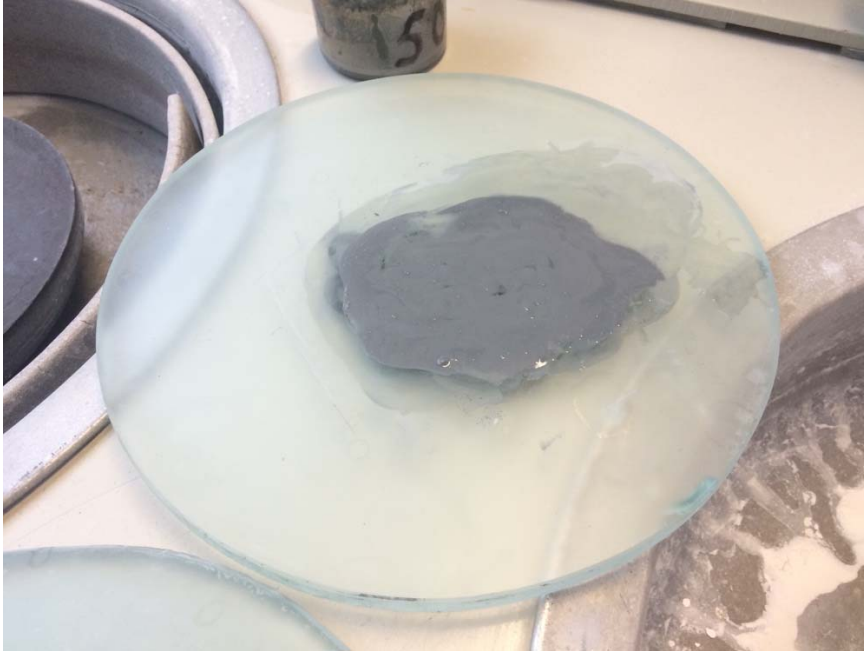
Figure 66: plateau de verre sur lequel on applique de la poudre abrasive (500, 800 et 1200 grains par centimètre carré). On rajoute de l'eau afin de créer une pate abrasive.
