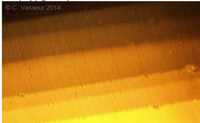
Figure 20: lignes courbes dans un saphir jaune synthétique "Verneuil" (C. Vasseur, 2014).
