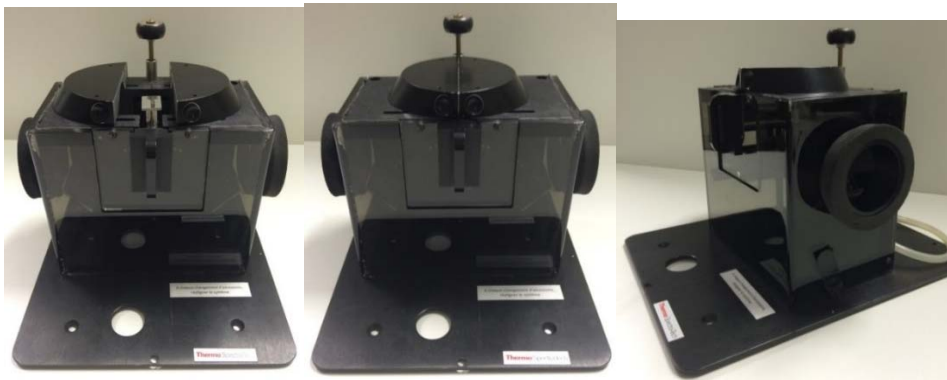
Figure 37: accessoire de réflectance diffuse utilisé en spectroscopie infrarouge par transmission (position ouverte, fermée et vue de profil).
