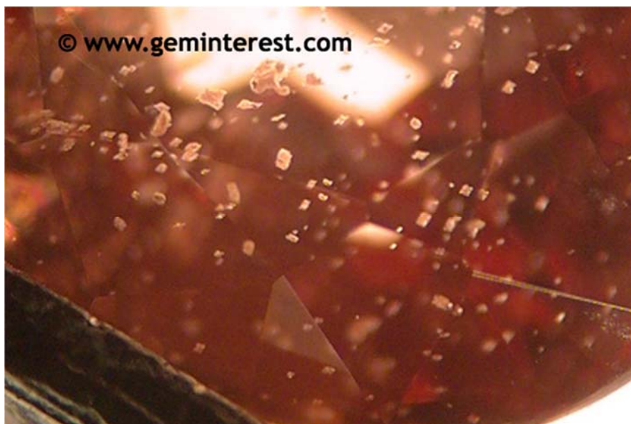
Figure 14: cristaux dégradés à l'aspect « mie de pain » par les hautes températures dans un saphir orange traité béryllium (Geminterest.com, 2016).
