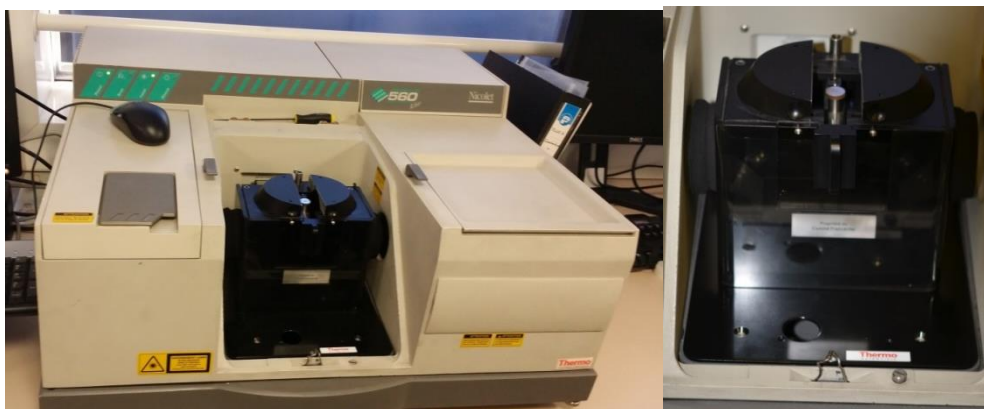
Figure 12 : Spectromètre d'absorption infrarouge à transformée de Fourier NICOLET MAGNA 560 et son accessoire sphère intégratrice
