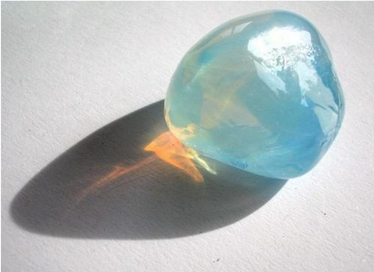
Figure n°3 : Effet Tyndall dans un verre opalescent : le verre apparaît bleu sur les côtés, mais une lumière orange passe à travers (© Wikipédia).
