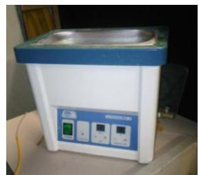
Fig. 10 : nettoyeur ultrasons
