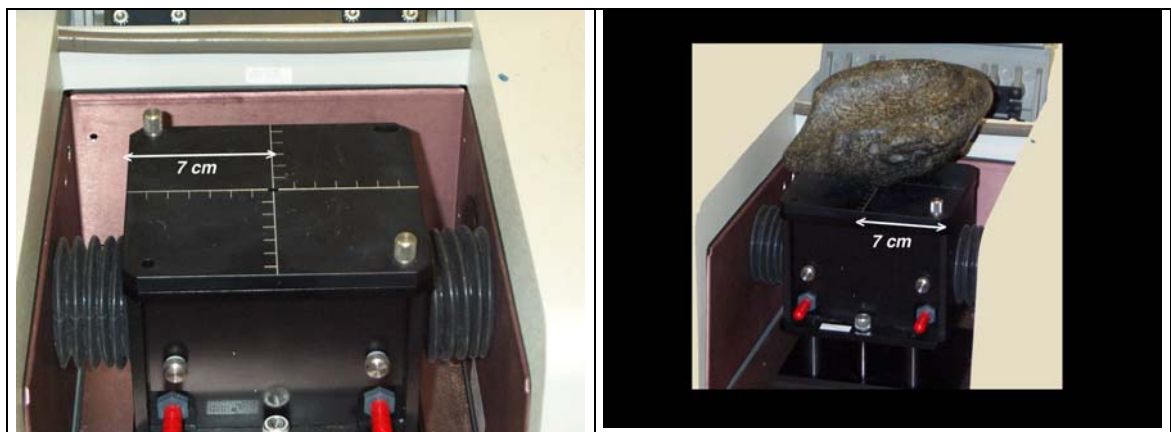
Figs. 5 et 6 L'infrarouge avec une partie de l'accessoire ATR Diamant utilisé pour la réflectance spéculaire (fig. 5) ; prise des données avec un masque aztèque (fig. 6)
