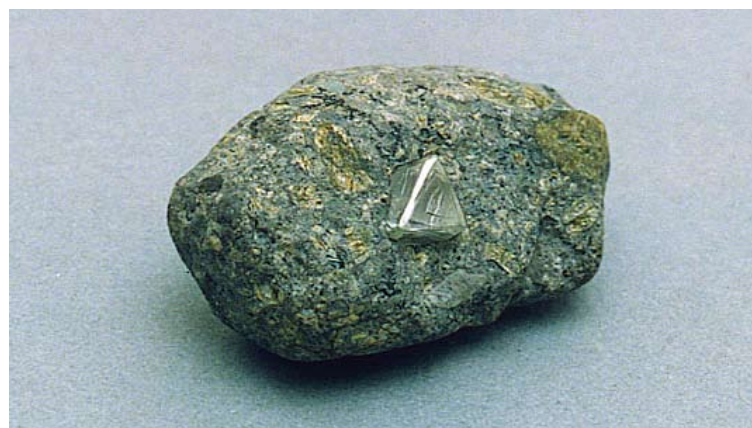
Figure 3.3 Un octaèdre de diamant dans un bloc de kimberlite. Gracieuseté de Diarough Canada.
