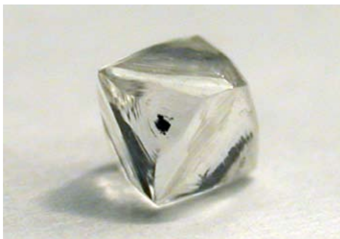
Figure 3.7 L'échantillon YM 020 contient une inclusion de type « tache de carbone », facile à observer à l'œil nu.
