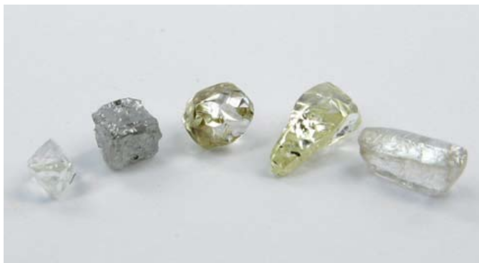
Figure 8.3 Cinq cristaux de diamants qui montrent différentes morphologie : un octaèdre (YM 019; 0,36 ct), un cuboïde (YM 016; 0,63 ct), un rhombododécaèdre (YM 006; 0,73 ct), un diamant de forme pyramidale allongée (YM 005; 1,11 ct) et un diamant maclé (YM 001; 0,88 ct).
