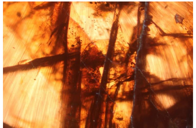
Amas de fractures oxydées au centre d'un grenat : Photo x4
