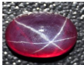
Figure 21 : Rubis synthétique fusion par flamme 12.85 ct (Verneuil), traité thermiquement (haute température), astérisme étoilé 6 branches.
