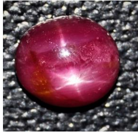
Figure 1 : Rubis naturel cabochon étoilé à six branches (astérisme), dont les fractures sont remplies au verre au plomb, 4.68 ct.
