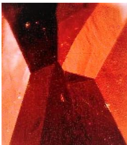
Figures 44 & 45 : inclusion liquide, clous, bulles de gaz, zonations de couleurs et l'effet sirupeux (IP).
