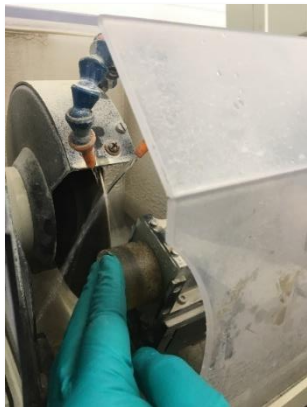
Fig. 52 : Une fois collé sur la lame porte-objet, on choisit l'épaisseur que l'on souhaite obtenir pour la lame mince (environ 30 microns) et on scie l'échantillon à cette épaisseur.
