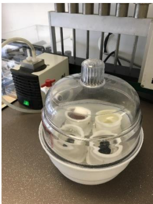
Fig. 48 : On place les moules dans un appareil d'imprégnation sous vide pour faire le vide, c'est-à-dire pour extraire toute trace d'air.
