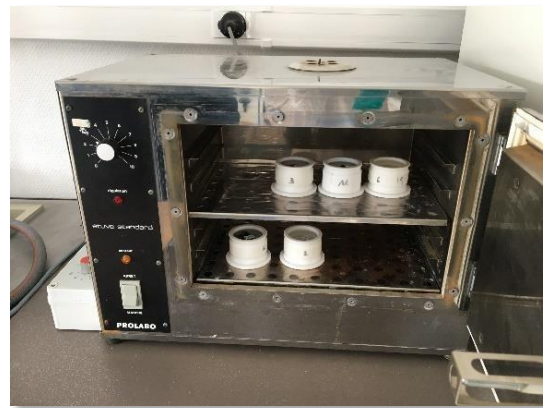
Fig. 49 : On place les échantillons dans l'étuve réglée à 60°C pour permettre le durcissement de la résine pendant environ 4 heures.
