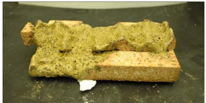
Lors des paliers de chauffage, avec les échantillons du DUG cette fois, les "symptômes" se sont faits ressentir lors des paliers entre 700°C et 850°C; les porte-échantillons, peu à peu altérés, sont devenus inutilisables après le chauffage à 900°C.
