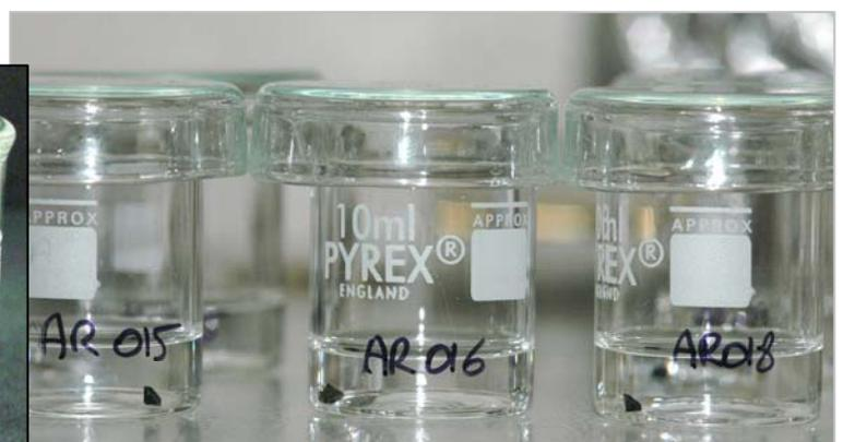
Trois échantillons dans de l'acétone afin de les dégraisser avant chauffage.
