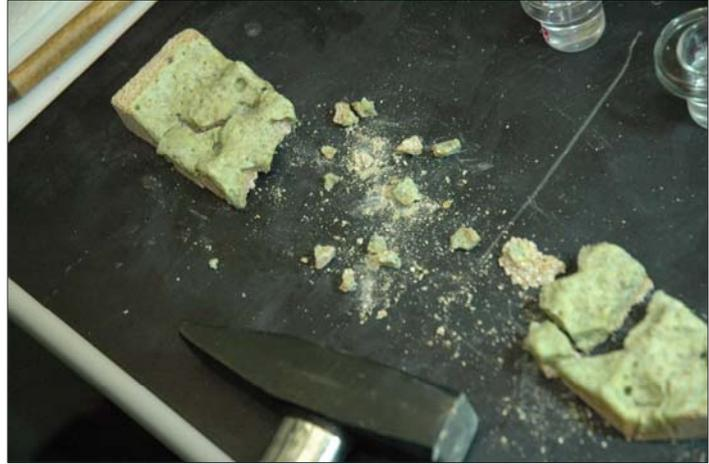
Fig. 3.11 et 3.11 bis - La plaque fendue suite au choc thermique et "l'extraction" des échantillons au marteau!
