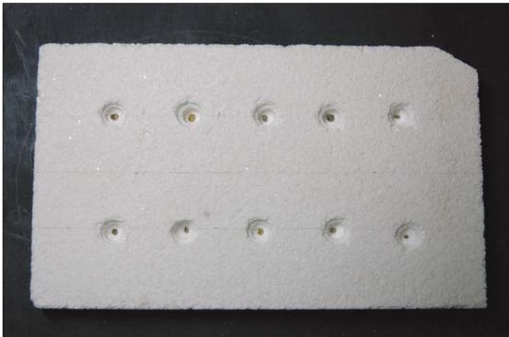
Fig. 3.12 - La plaque en sillimanite avec les dix logements dans lesquels on aperçoit les échantillons avant chauffage.
