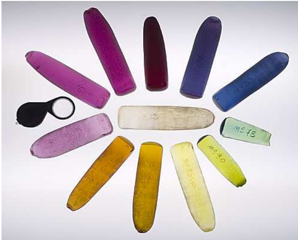
Figure N°2 : Boules de spinelles synthétique Verneuil, montrant l'aspect allongé caractéristique
