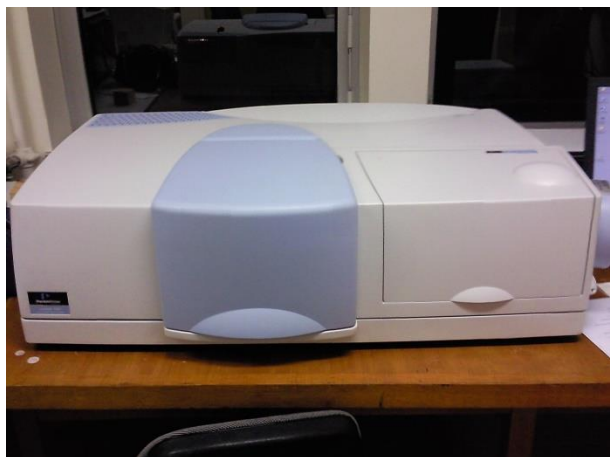
Figure 5 : vue du matériel dans son ensemble. Spectromètre d'absorption UV-Vis-PIR, modèle Perkin Elmer Lambda 1050. Institut des Matériaux, Université de Nantes.
