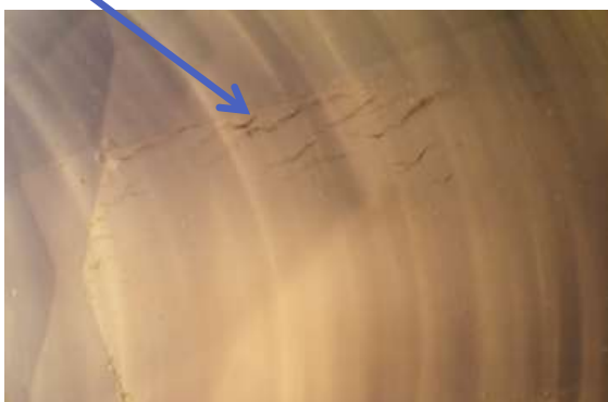
Photo 6-9 : CV36 lignes courbes et vaguelettes (craquelures superficielles)
