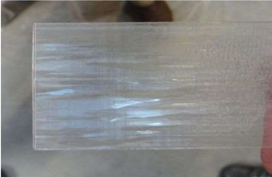
Figure 16-1: corindon synthétique, méthode Stepanov
