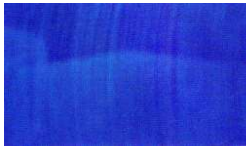
Photo 3-8: ligne courbe détectée dans un corindon incolore grâce aux UV courts (photo ELEN, 1999)
