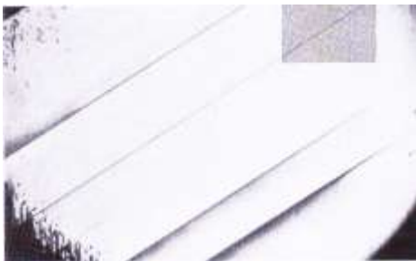
Photo 3-11 : Macles parallèles (Eppler, 1964)
