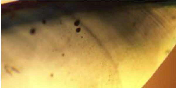
Photo 6-1 : CV33 lignes courbes accentuées par le défaut d'homogénéité d'élément colorant, bulles assez grosses.
