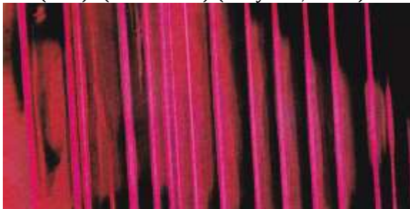
Photo 2-6 : corindon naturel : Macles polysynthétiques sous microscope en lumière oblique, elles se distinguent clairement les unes des autres. (Gübelin, 1983) et Macles polysynthétiques au microscope en immersion avec polarisateurs croisés. 40x (Gübelin, 1988)
