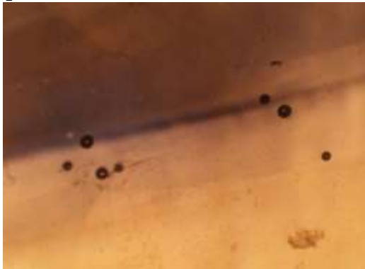
Photo 5-9: bulles de gaz dans un Verneuil
