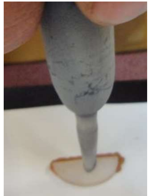
Le germe est placé sur la barre d'alumine.
