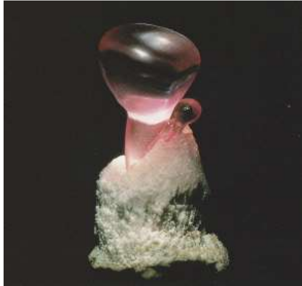
Photo 3-2: Boule Synthétique Verneuil encore sur son cône, On aperçoit une germination secondaire. (Hughes, 1997)
