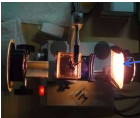
Photo 5-8: vue en hauteur, cuvette et brucelles, lampe et filtre mat
