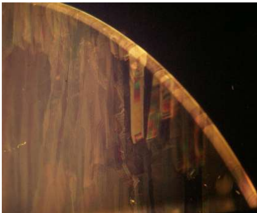
Photo 6-60 Verre de montre en corindon incolore CV49 au microscope en immersion sous polariseurs croisés
