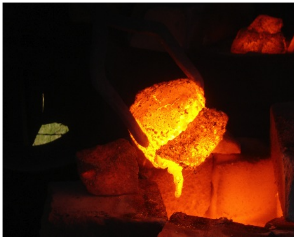
Figure 36 : Extraction du creuset
