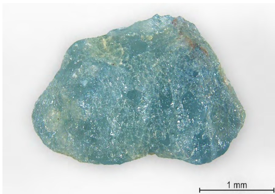
Figure 6 : Cristal de davyne bleu-vert, échantillon SGDF-15812. Photo capturée avec un Leica M205C équipé d'une caméra DMC5400, en mode Z-stack, illumination épiscopique, photo F. Notari, 2025.
