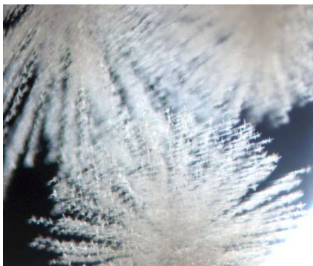
Figure 4 : a) Détail des « boules » montrant qu'il s'agit de lignes d'éclatements (Largeur du champ : 5,5 mm) b) Chaque « ligne » est finie par un éclatement plus important (Largeur du champ : 5 mm). Photos A. Delaunay.
