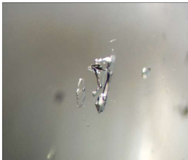
Figure 2 : À gauche : Figure optique « bull's eye » observée sous polariseurs croisés. À droite : Les inclusions biphasées démontrent que le quartz a une origine naturelle (Largeur du champ : 2.8 mm). Photos S. Riou & A. Delaunay.
